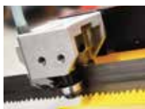
Sägebandführung aus Hartmetall
