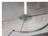
Runder Auflagetisch Die Maschine verfügt über einen, bei Gehrungsschnitten mitdrehenden, Auflagetisch. Dadurch gibt es keine Einschnitte
